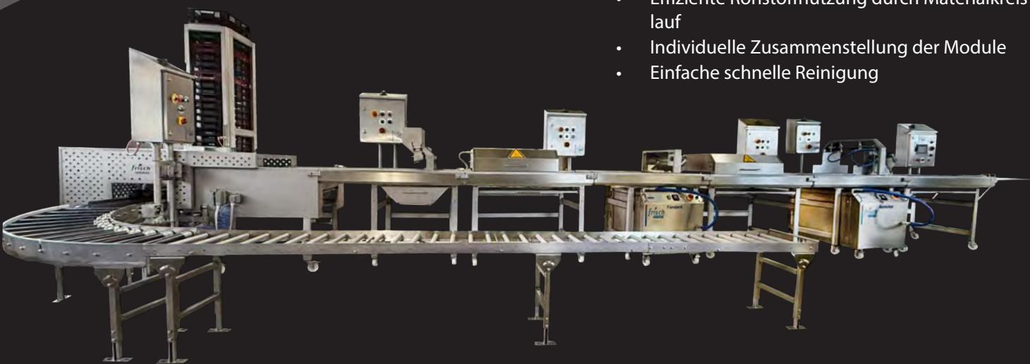
Aprikotieren, Trocknen, Glasieren, Dekorieren und Vorkommissionieren - alles in einem Zug!
