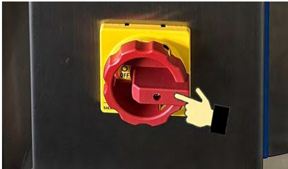
Abbildung 58: Hauptschalter am Bedienfeld ausschalten
