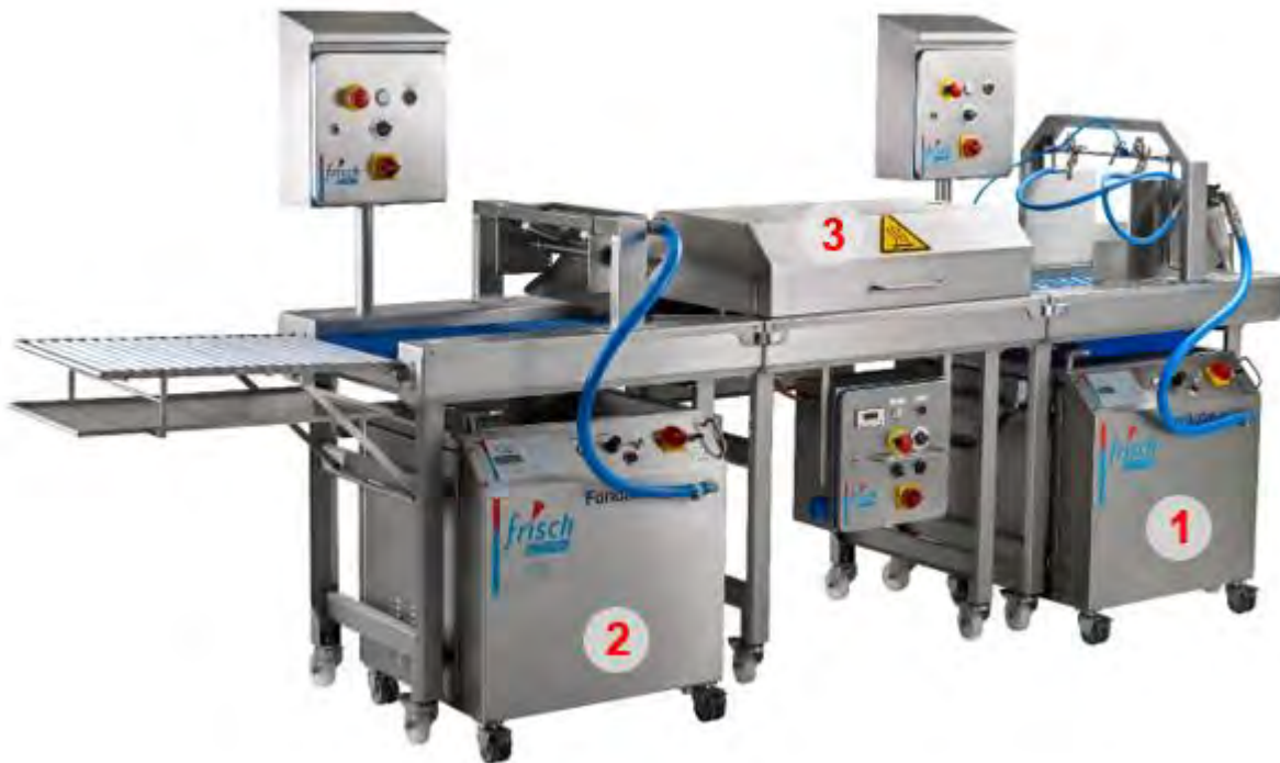
Abbildung 1: Beispiel-Kombination der Heizmaschinen und einer Combino Bandanlage
