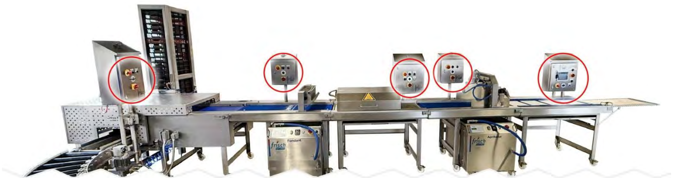
Abbildung 41: Positionen der Schaltschränke
