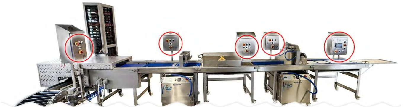
Abbildung 71: Positionen der Schaltschränke
