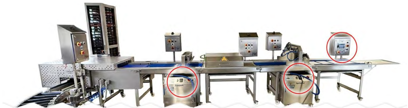
Abbildung 56: Position des HMI-Panels
