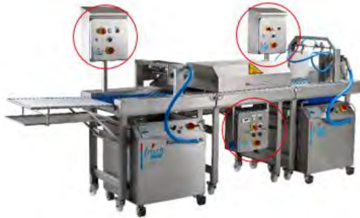
Abbildung 44: Positionen der Schaltschränke
