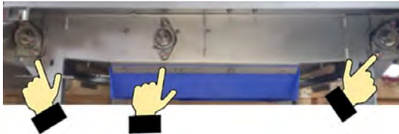
Abbildung 60: Lagerblöcke an der Bandanlage
