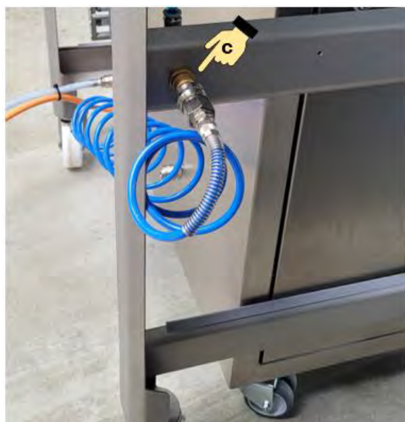
Abbildung 20: Druckluftversorgung herstellen Apriband
