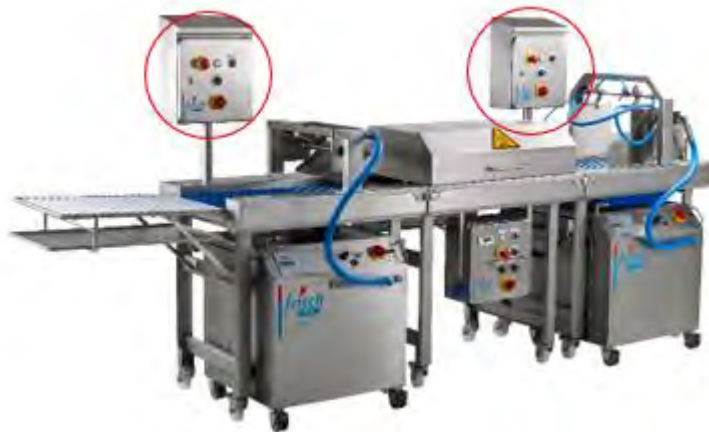
Abbildung 34: Positionen der Schaltschränke
