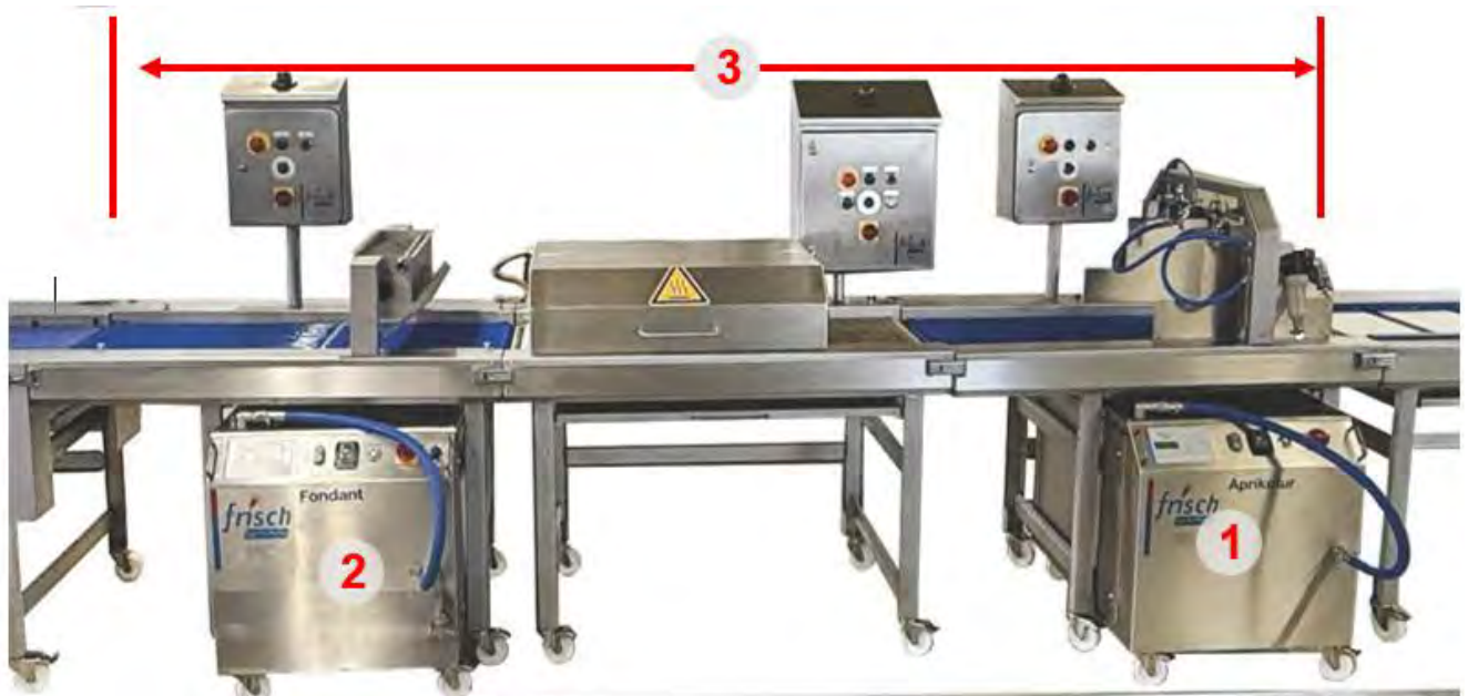
Abbildung 1: Beispiel-Kombination der großen Heizmaschine und einer Bandanlage
