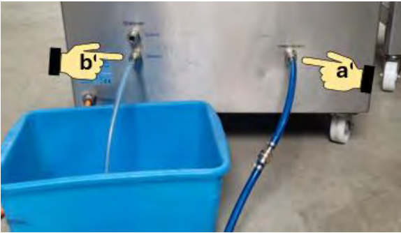
Abbildung 48: HZ mit Leitwertsensor spülen
