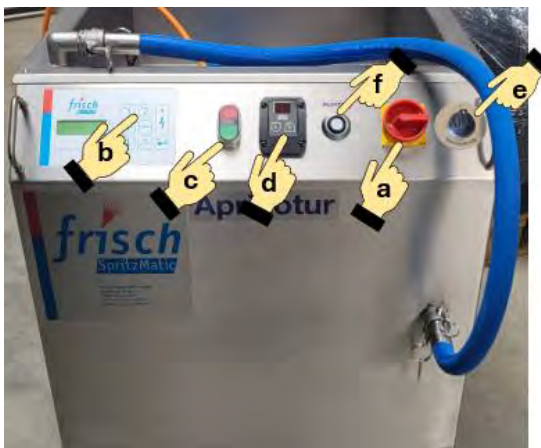
Abbildung 52: HZ mit LWS einschalten
