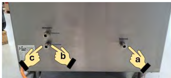
Abbildung 47: HZ ohne Leitwertsensor spülen
