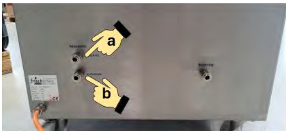
Abbildung 46: HZ mit Fettglasur spülen
